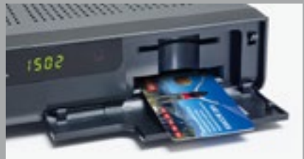
Karte falsch im Satelliten-Receiver → mit Viaccess-Modul einschieben ✗
