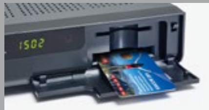
Karte falsch im Satelliten-Receiver → mit Viaccess-Modul einschieben ✗
