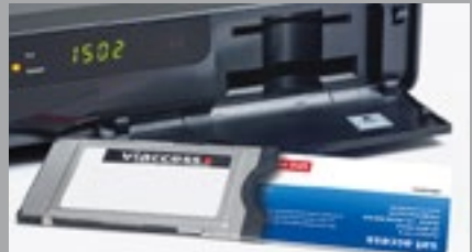
Karte falsch im Viaccess-Modul → Karte wenden/drehen ✗
