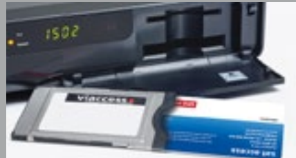
Karte falsch im Viaccess-Modul → Karte wenden/drehen ✗
