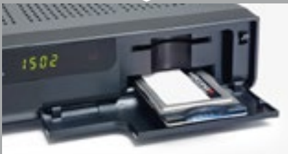
Viaccess-Modul richtig im Satelliten-Receiver ✓
