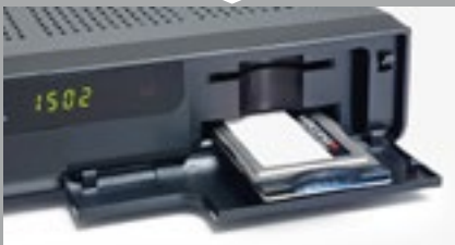
Viaccess-Modul richtig im Satelliten-Receiver ✓
