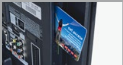
Karte falsch im Fernseher → mit Viaccess-Modul einschieben ✗
