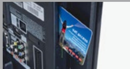
Karte falsch im Fernseher → mit Viaccess-Modul einschieben ✗
